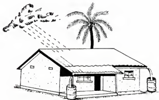
FIGURE 5 L'eau des toits est recueillie
